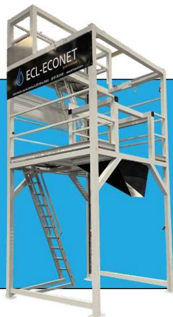
Système de réglage permettant d'accueillir des bennes de 800 à 2500 litres de la marque SECATOL et EICHINGER.
